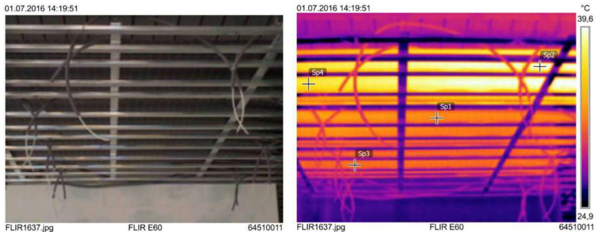
Fig. 1 – Beispiel für eine Kontrolle mit Infrarot Kamera vor der Montage der abgehängten Zwischendecke
