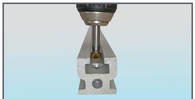
... Locher innen senken mit Spezialsenker
